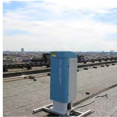
Bodengestützte Fernerkundung der urbanen Grenzschicht für Profile der Lufttemperatur, Luftfeuchte, Aerosole, Windgeschwindigkeit und Windrichtung sowie Wolken und Niederschlag
