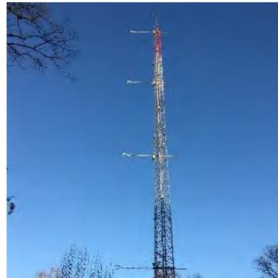
Meteorologische Türme für die lokale Erfassung der Strahlungsbilanz und des turbulenten Austauschs von Wärme, Feuchtigkeit und Kohlenstoffdioxid sowie phänologische Beobachtung
